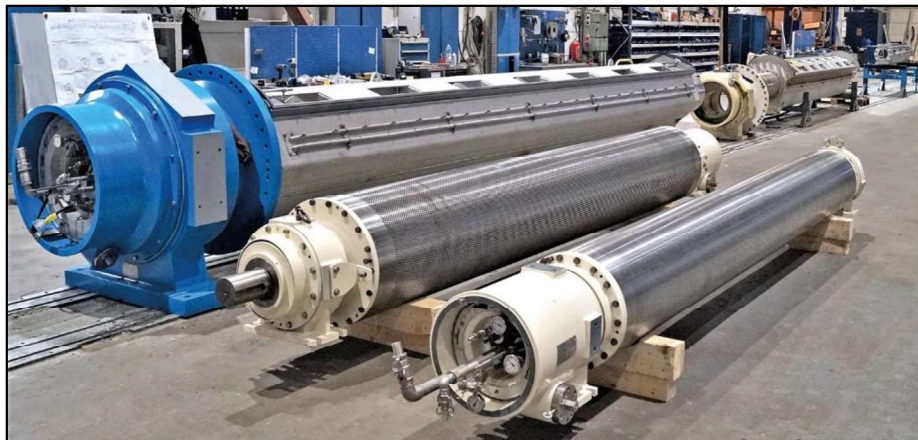
Cilindro de sucção desmontado – Fornecido pelo fabricante.
